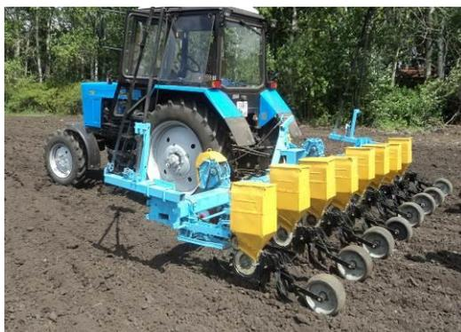
Рисунок 1- Модернизированная сеялка для высева капсулированных семян
