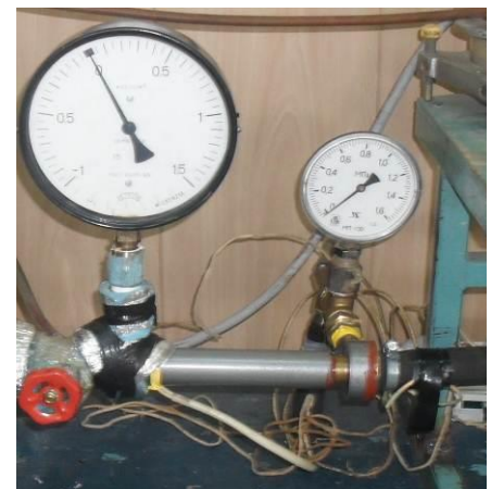
Рисунок 4 – Общий вид вихревой трубы
