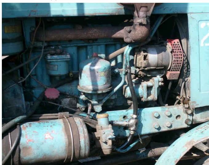
Рисунок 3 Место установки датчика в масляной магистрали трактора МТЗ-80
